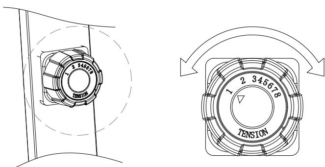
Okrenite dugme za zatezanje (17) u smeru kazaljke na satu da biste povećali nivo otpora, okrećite u suprotnom smeru od smera kazaljke na satu da biste smanjili nivo otpora. Nivo 1 je najniži, a nivo 8 najviši
