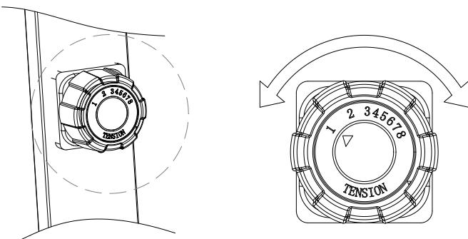
Okrenite dugme za zatezanje (17) u smeru kazaljke na satu da biste povećali nivo otpora, okrenite u suprotnom smeru od smera kazaljke na satu da biste smanjili nivo otpora. Nivo 1 je najniži, a nivo 8 najviši
