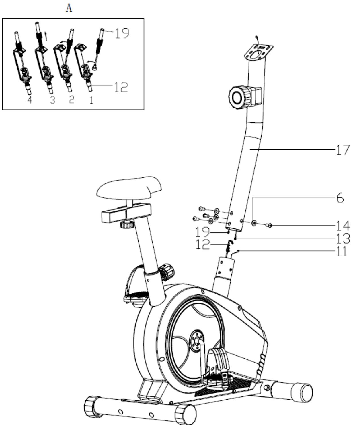
**C:** Nakon što se uverite da su sve žice dobro povezane, tada fiksirajte stub guvernala (17) na držač glavnog rama (1) pomoću unutrašnjih šestougaonih šrafova (14) i lučnih prstenova (6).
