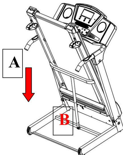
Držite mesto A rukom, udarite mesto B poluge vazdušnog pritiska, onda će osnovni okvir pasti automatski
